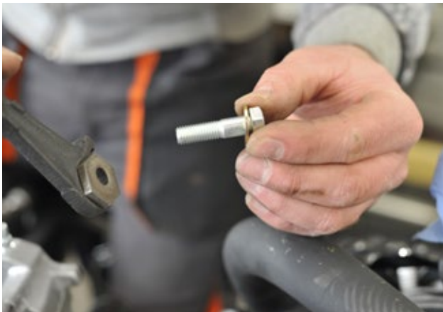
Plaats de handremhevels met excentrieken op de remklauw. (Her te gebruiken van de donor).
