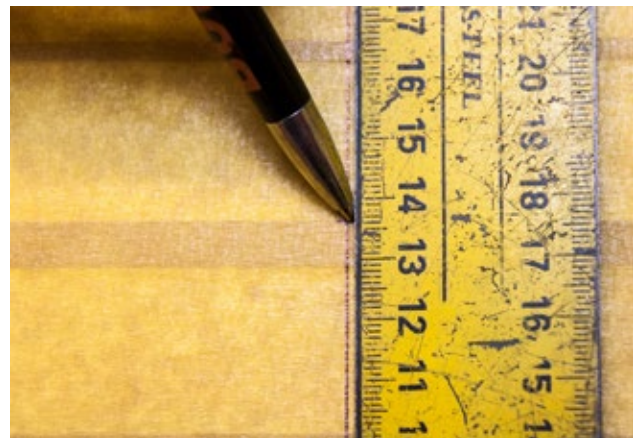
Voorruit en ontwasemingsplaatje op 136mm aftekenen.
