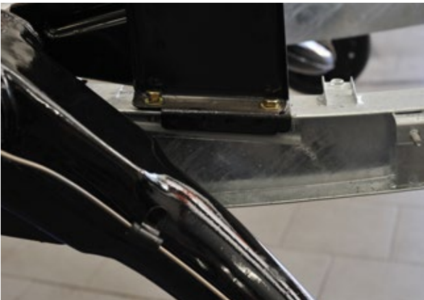
Monteer de tankbeugel aan het chassis.
