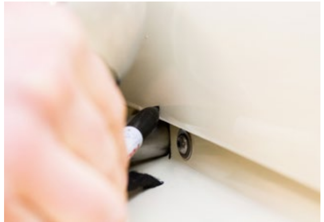
Bepaal het gat voor de koplampbeugel.
